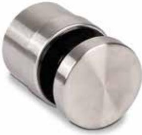
Dieser einzigartige Glasadapter ist eine Ergänzung des kompletten Onlevel-Sortiments. Der Adapter mit einem Durchmesser von 50 mm hat die Eigenschaft, nach der Montage des Glases verstellbar zu sein. Diese Verstellung erfolgt mit einem speziellen Werkzeug.
