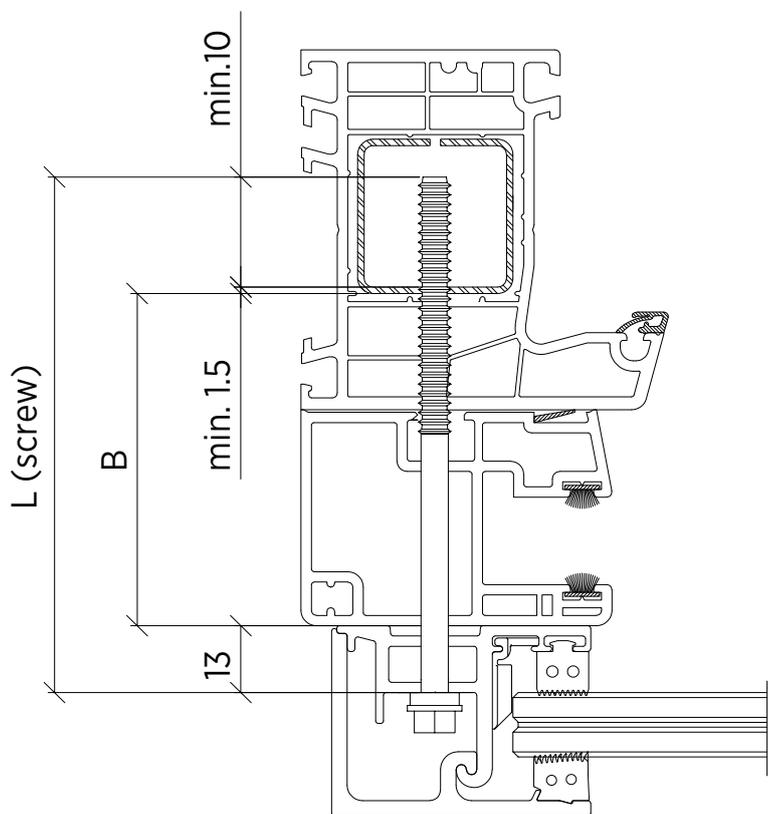
$L_{\text{min. screw}} = B + 25\text{mm}$
