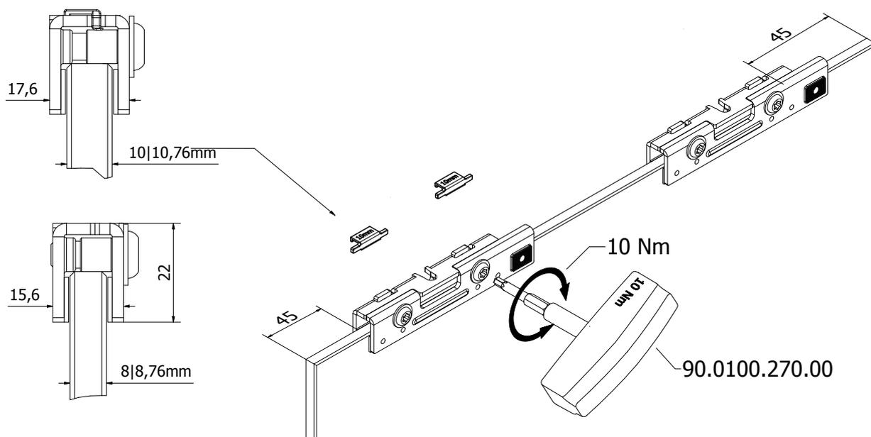
Der Klemmbereich muss sehr gut mit Glasreiniger oder ähnlichem gereinigt werden und muss trocken sowie frei von Staub, Fett und Schmutz sein
